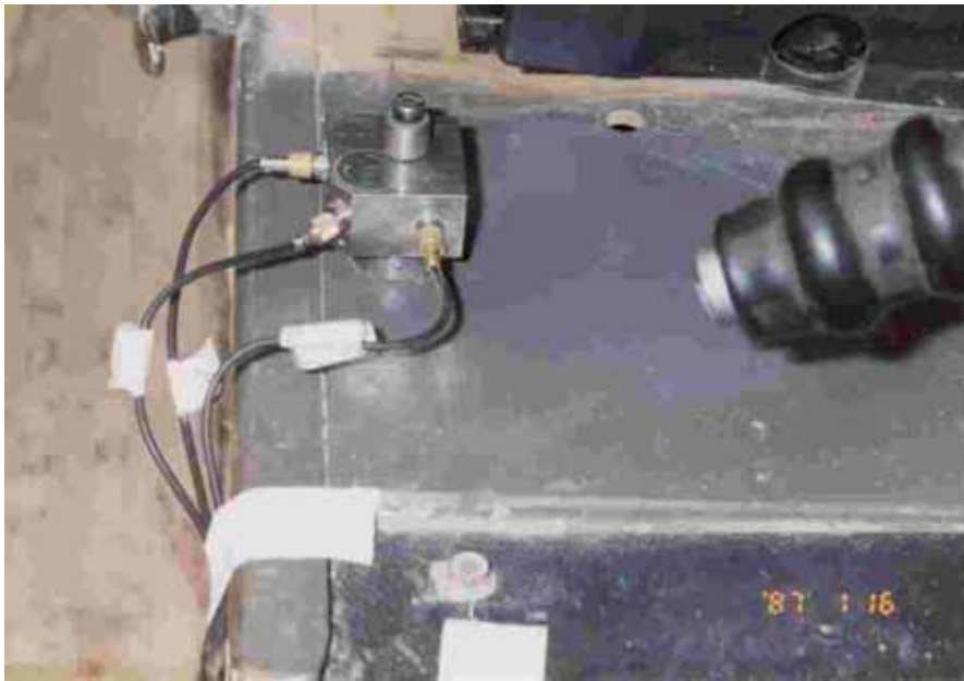
Bild 12: Triaxial-Beschleunigungsaufnehmer B&K 4321 am Chassis (Plattform - Sitzmontagepunkt)
