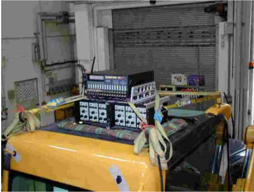
Bild 10: 6-kanalige Schwingungsmesskette der Tiefbau-Berufsgenossenschaft
