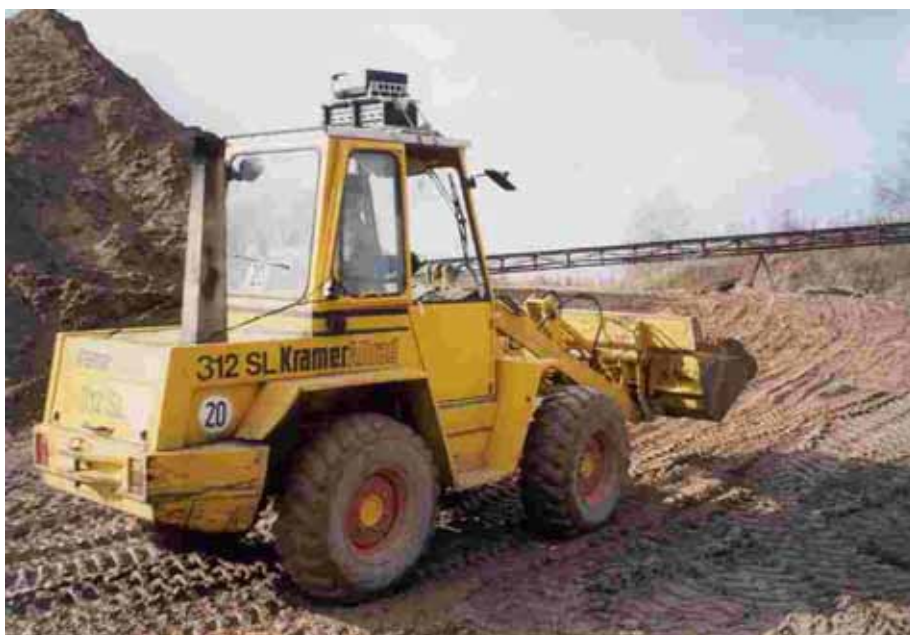
Bild 13: typische Anordnung der Messausrüstung an einem Kompaktlader
