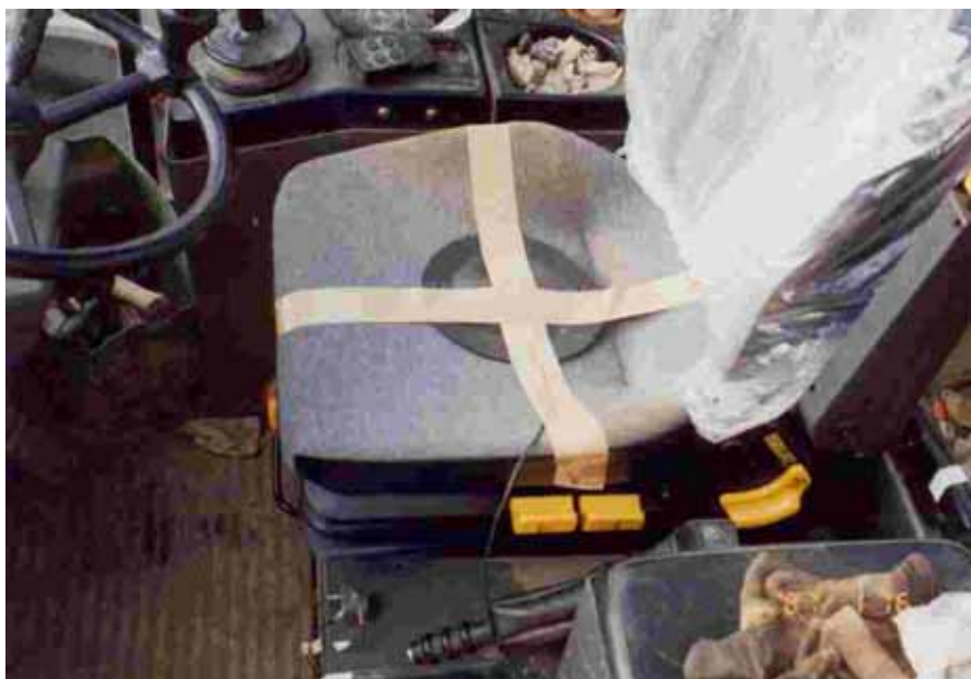
Bild 11: Triaxial-Beschleunigungsaufnehmer B&K 4322 auf dem Sitz
